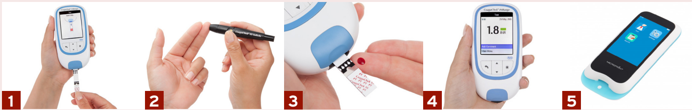
1 - 4: Beispielhafter Ablauf für die Selbstbestimmung des Gerinnungswertes (© Roche Diagnostics)
